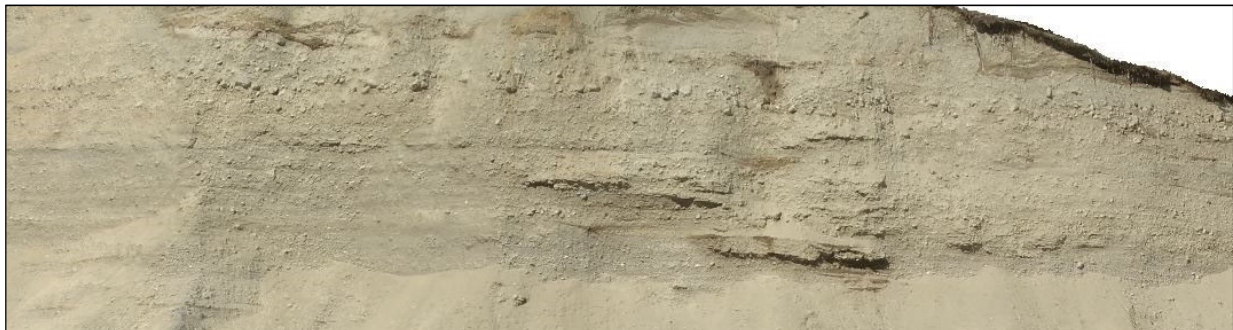
Abb. 02: Screenshot vom Ausschnitt eines 3D-Modells einer terrestrisch aufgenommenen Kiesgrube mit naturgetreuer Fototextur (die untere Seite misst etwa 40 m Länge). Es sind fluvatile Ablagerungsstrukturen zu erkennen, die in ihrer Mächtigkeit und Raumlage aus dem Modell herausgemessen werden können.
