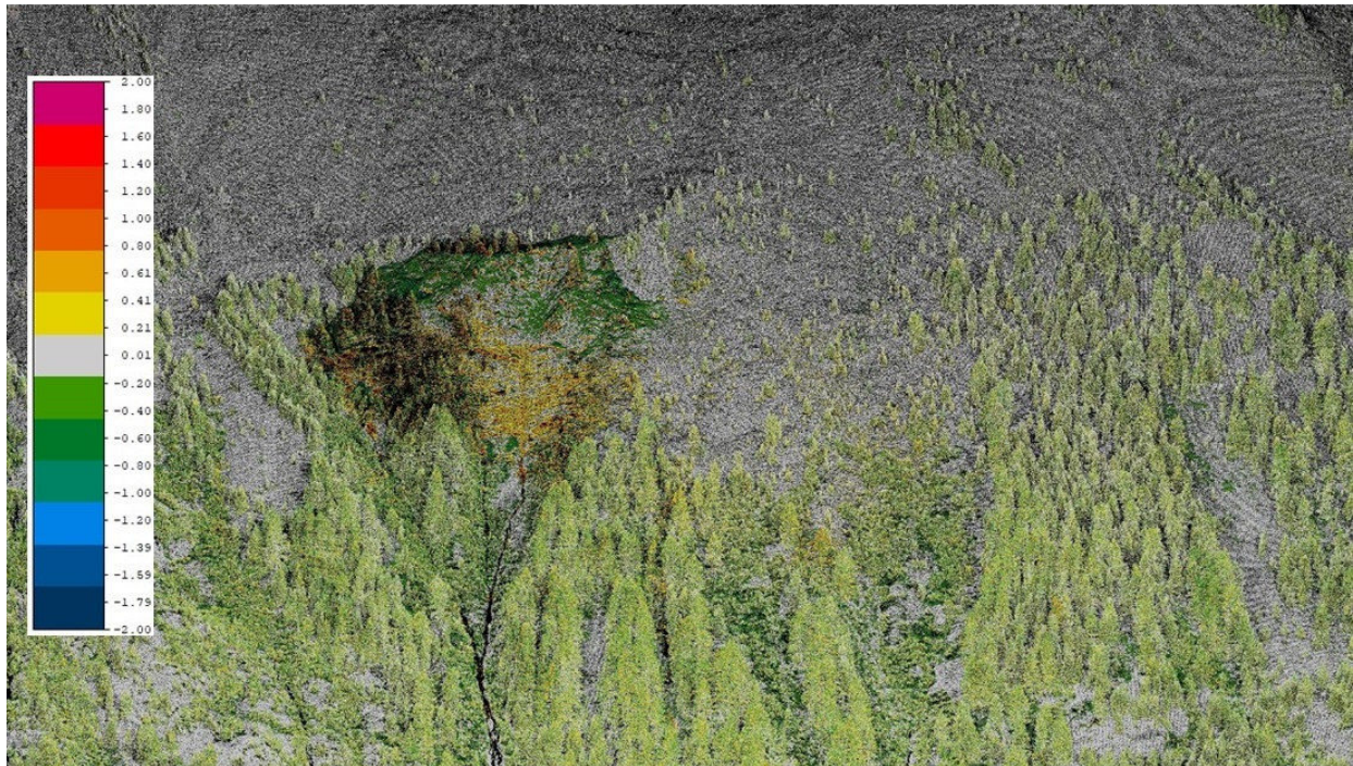
Abbildung 3: 3D-Ansicht der Distanzen zwischen den Punktwolken der Epochen 01.08.2019 und 15.10.2019 (mobiles Scan-Setup).
